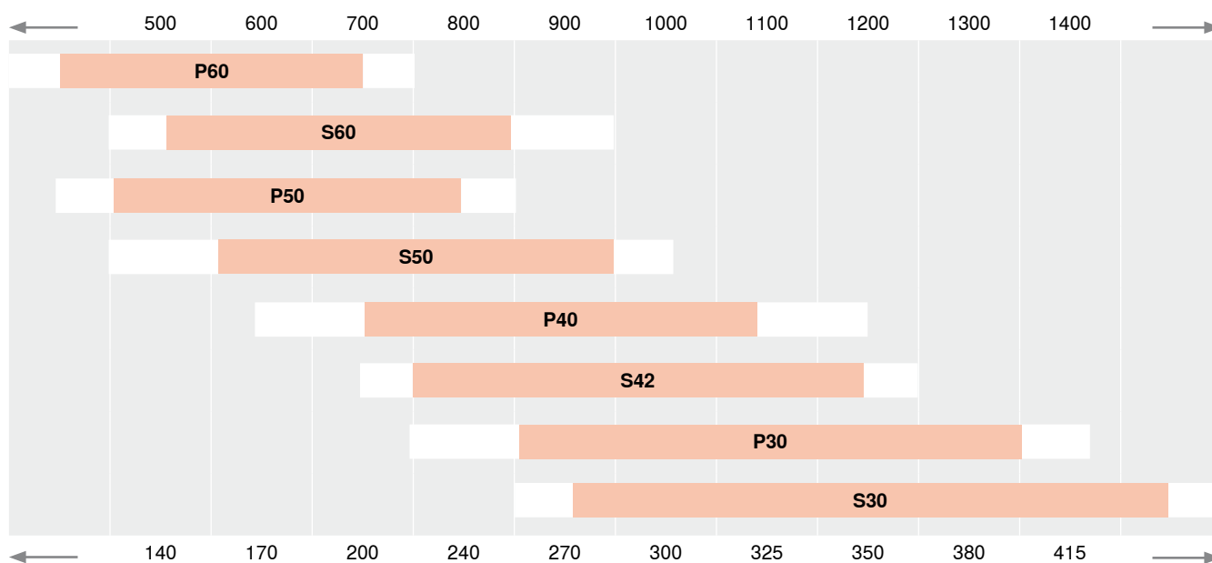
Empfohlener Einsatzbereich der Stützfasen auf Basis der BRINELL-Härte des Stahlwerkstoffes (HB)
