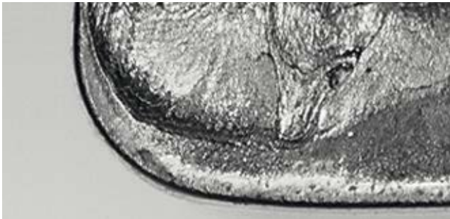
Der ablaufende heiße Span verursacht eine Auskolkung der Schneidplatte an der Spanfläche.
