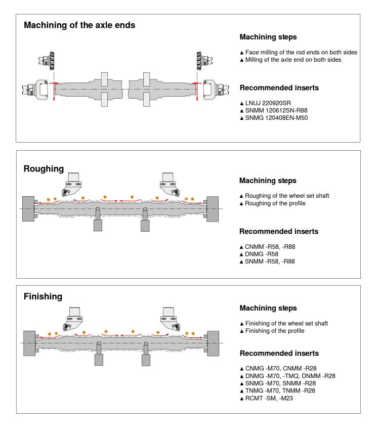
MACHINING THE AXLE ENDS
