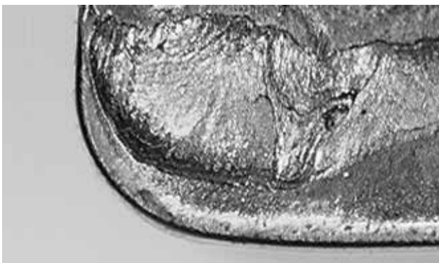
Der ablaufende heiße Span verursacht eine Auskolkung der Schneidplatte an der Spanfläche.
