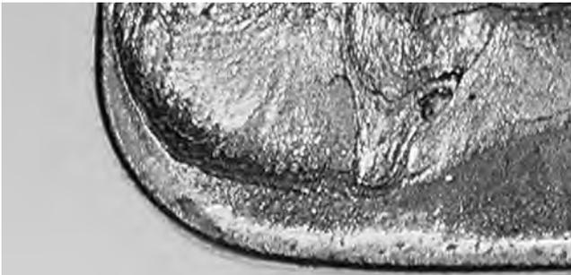
Der ablaufende heiße Span verursacht eine Auskolkung der Schneidplatte an der Spanfläche.
