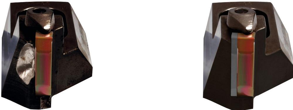
El uso de placas base de MDI evita los desprendimientos, las deformaciones y las hendiduras en el portaherramientas
