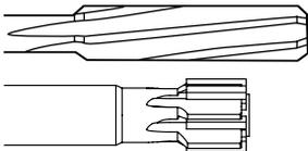
Negli alesatori a macchina e alesatori HSR vengono riaffilati l'imbocco, il fianco e il diametro esterno, gli alesatori vengono di nuovo rivestiti con il loro rivestimento originale.
