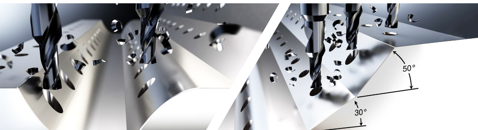
Este posibilă găurirea directă a suprafețelor convexe și concave
