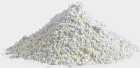
Boornitride met hexagonale rasterstructuur
