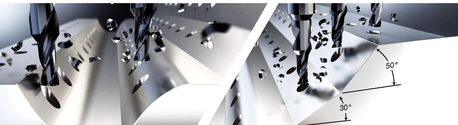
Possibilidade de furação direta de superfícies convexas e côncavas
