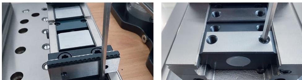
Arka itici, Allen başlı dişli pim ile bloke edilir ve DSG 4 tekli mengene olarak da kullanılabilir.
