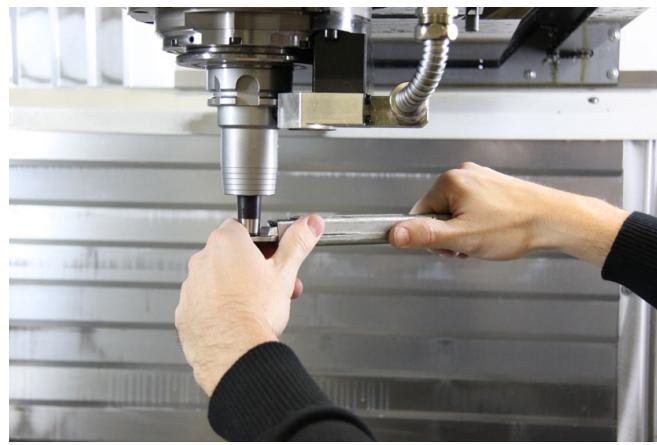
Doğru sıkma işlemi için diğer eliniz ile ucu destekleyerek oluşturabileceğiniz balansı yada sıkma hatasını önlemiş olursunuz.
