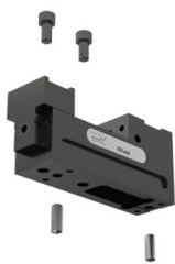
Temel versiyonda konumlandırma, 40 mm ESG mininin izgara plakaları (**Ürün kodu 80 897 944 ve 80 897 946**) ve T kanallı makine tezgahı üzerinde hizalanıldığı, 2 Ø8<sup>H7</sup> konumlandırma deliği ile gerçekleştiriliyor. 40 mm ESG mini, 2 adet M8 sabitleme civatası ile üstten sabitlenebilir.
