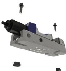
Ana gövdedeki, boyuna veya enine 20<sup>H7</sup> kanalına sahip kanallı tezgâhta hassas kayar bloklar ile hizalama
