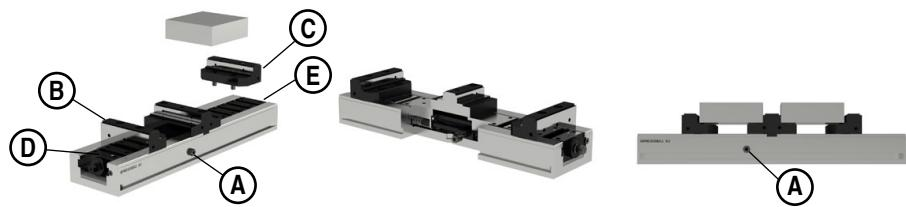
Yanal sıkma vidası A iyice sıkılmaz, aksine yakl. yarı tur açık bırakılır. Sıkma aracı azami ölçüde açıkken, B ve C hareketli sıkma yanakları iticinin uygun olan D ve E kanallarına takılmalı ve iş parçasının büyülüğüne göre sabitlenmelidir. Aynı anda 2 farklı büyülüklükte iş parçasını germek de olanaklıdır.
