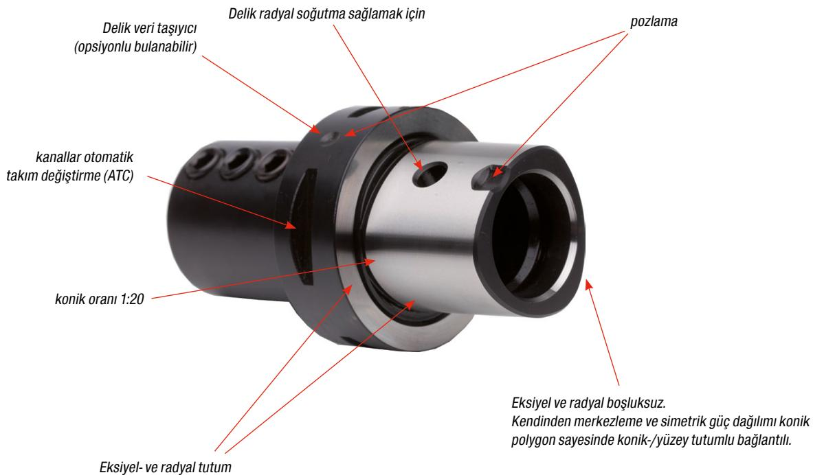
Konik Polygon sayesinde sıkı bir tolerans bağlantılı olarak sürükleme aracı olarak. PSC-koni çok yüksek sertlik ve eğilme mukavemetine sahiptir. Bu arabiriminin ana avantajları diğer taraftan radyal olarak etki eden kuvvetlere karşı bulaşıcı tork ve stabilité ile bir yandan Kesin merkez yüksekligi. Bu büyük malzeme kesitleri işlenebilir olabilir veya yüksek ilerleme hızları fark anlamına gelir. PSC arabirim bundan dolayı delme, tornalam ve frezelemede en ideal seçimdir.
