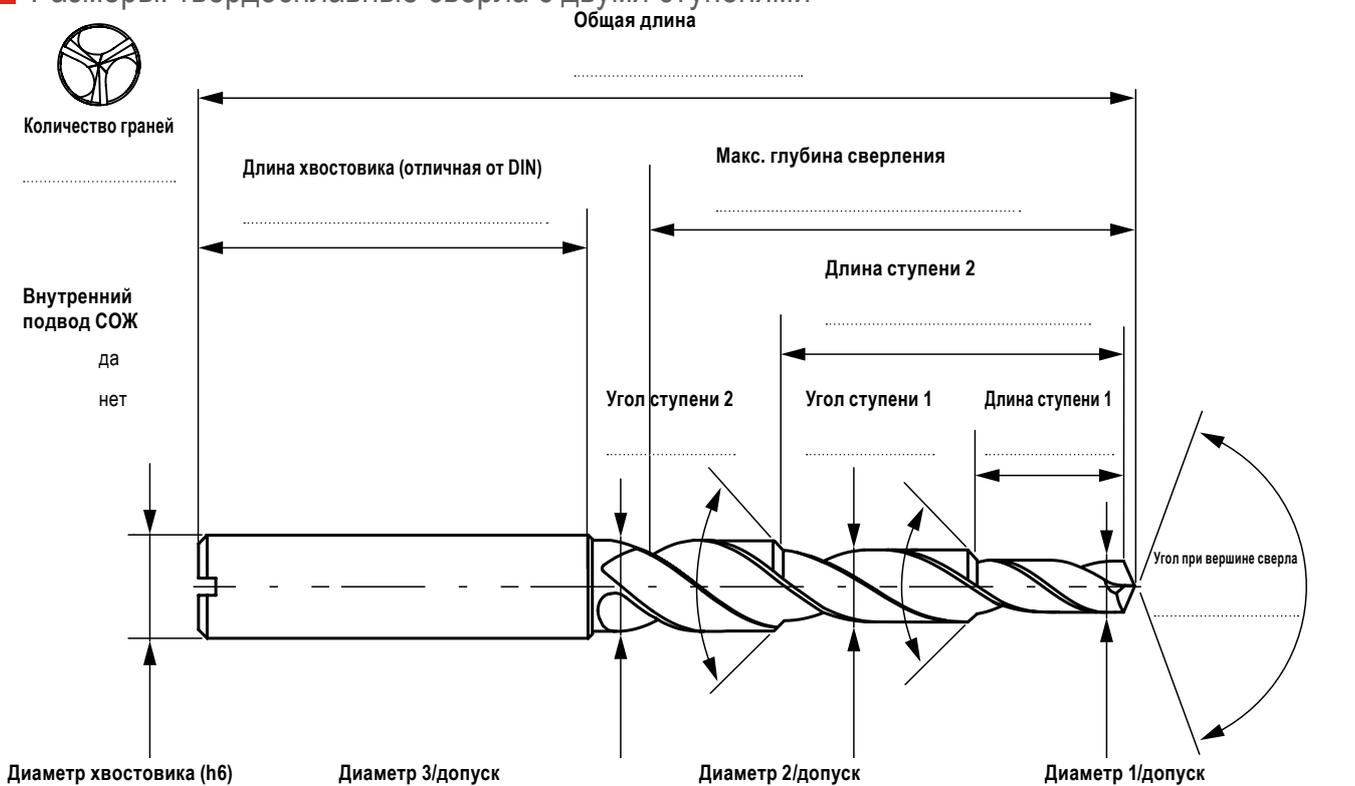
**i** Вследствие требований по производительности угол при вершине у свёрл не является постоянным и рядом с осью он больше. Если постоянный угол при вершине является обязательным условием, пожалуйста, укажите.
