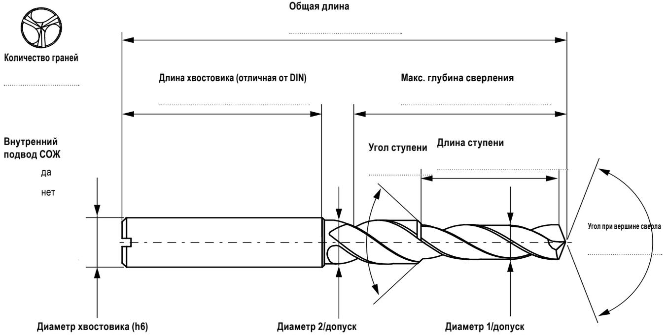
**i** Вследствие требований по производительности угол при вершине у свёрл не является постоянным и рядом с осью он больше. Если постоянный угол при вершине является обязательным условием, пожалуйста, укажите.
