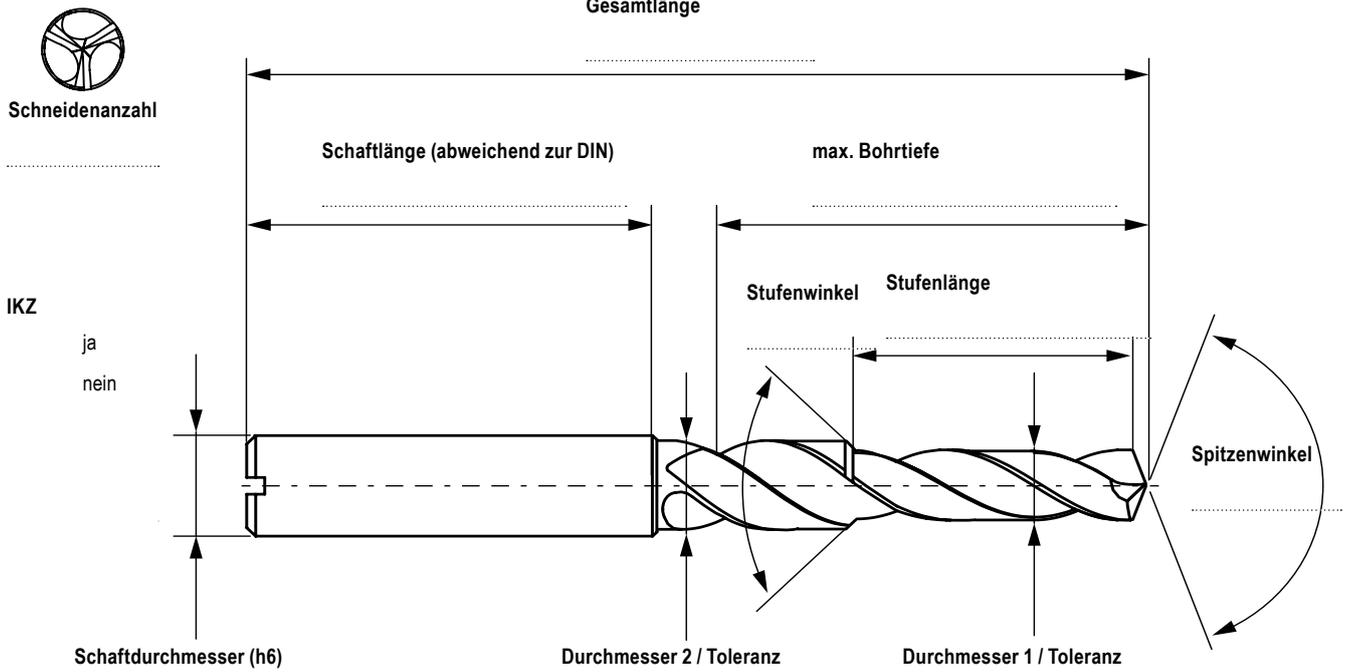
**i** Aufgrund der Leistungsanforderungen ist der Spitzenwinkel der Bohrwerkzeuge nicht konstant und in der Nähe der Achse größer. Wenn ein konstanter Spitzenwinkel wichtig ist, bitte angeben.
