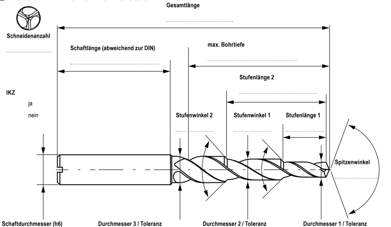
**i** Aufgrund der Leistungsanforderungen ist der Spitzenwinkel der Bohrwerkzeuge nicht konstant und in der Nähe der Achse größer. Wenn ein konstanter Spitzenwinkel wichtig ist, bitte angeben.
