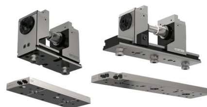
Alinhamento e fixação com o sistema de fixação de ponto zero MNG (2-3 pinos de tração). Opcional: Furos de posicionamento e montagem a pedido do cliente.
