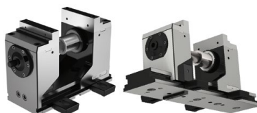
Alinhamento por meio de porca de precisão 20 H7 no corpo-base e conjuntos de alinhamento 14 / 16 / 18 no rasgo "T" da mesa da máquina. Fixação com grampos.
