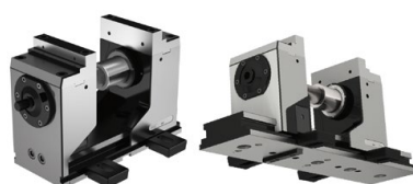
Regulacja przez korpus podstawowy (H5G) za pomocą wpustów precyzyjnych 20 H7 i zestawy regulacyjne 14 / 16 / 18 w rowkach teowych stołu obrabiarki. Mocowanie łapami mocującymi.
