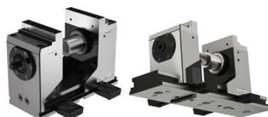
Uitlijning door precisie pasblokken 20 H7 in de basis (H5G) voor 14 / 16 / 18 mm T-gleuf van de machinetafel. Opspannen met klemvingers.
