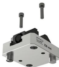
Fissaggio con due viti M6 dall'alto attraverso il corpo della base. Allineamento attraverso i fori di precisione  $\varnothing 12^{H7}$ .
