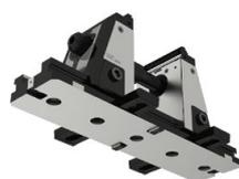
Allineamento mediante le chiavette di riferimento 20<sup>H7</sup> nella base della morsa (H5G) attraverso la scanalatura a T della tavola della macchina
