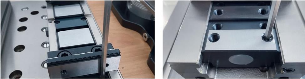
Tramite il grano filettato con esagono interno viene bloccata la guida posteriore e la DSG 4 può essere utilizzata anche come dispositivo di bloccaggio semplice.
