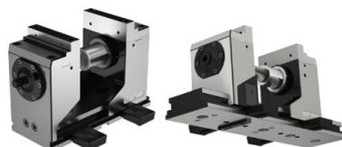
Allineamento mediante le chiavette di riferimento 20<sup>H7</sup> nella base della morsa (H5G) attraverso la scanalatura a T da 14/16/18 della tavola della macchina Staffaggio con staffe di fissaggio
