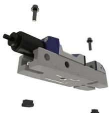
Allineamento mediante sede per chiavette di riferimento 20<sup>H7</sup>
