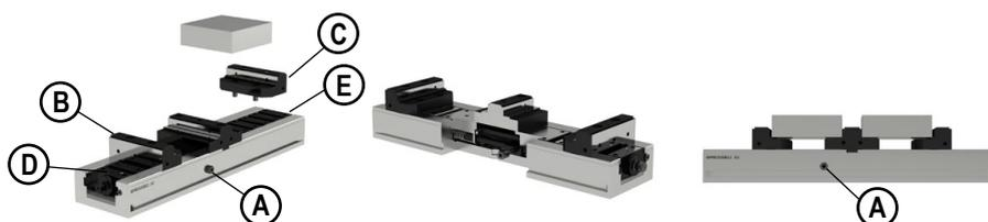
La vite laterale di serraggio A non è avvitata completamente, ma aperta di mezzo giro. Con il dispositivo di bloccaggio ad apertura massima le ganasce mobili B e C vanno posizionate nelle apposite scanalature delle guide D ed E montate tenendo conto della dimensione del pezzo. Si possono anche serrare due pezzi di dimensioni diverse.
