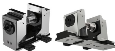
Beállítás az alaptesten (H5G) kialakított 20 H7 precíziós horonycsapok segítségével és 14-es / 16-os / 18-as beállítókészlettel a gépasztal T-hornyában. Felfogás szorítókarokkal.
