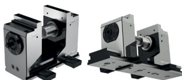
Justering via præcisions T-not møtrikker 20 H7 i grundkroppen (H5G) og justeringssæt 14/16/18 i maskinbordets T-not. Opspænding med spændejern.
