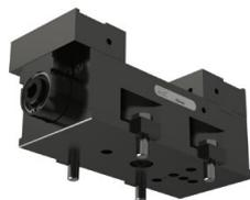
Le staffe di fissaggio codice 80897121 possono essere utilizzate per staffare l'ESG mini 100 direttamente con una dimensione del reticolo 100 mm x 100 mm su una piastra a reticolo (50 mm x 50 mm) o una piastra con scanalature a T con interasse di 100 mm.
