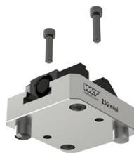
Fissaggio con due viti M6 dall'alto attraverso il corpo della base. Allineamento attraverso i fori di precisione  $\varnothing 12^{H7}$ .
