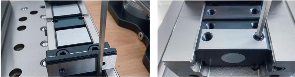
Tramite il grano filettato con esagono interno viene bloccata la guida posteriore e la DSG 4 può essere utilizzata anche come dispositivo di bloccaggio semplice. **Informazione importante:** Non è idonea dove vari dispositivi di bloccaggio semplici vengono usati uno accanto all'altro. Consigliamo la modifica con scanalatura trasversale supplementare nel corpo base e un adatto supporto fisso.
