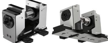
Allineamento mediante le chiavette di riferimento  $20^{H7}$  nella base della morsa (H5G) attraverso la scanalatura a T da 14/16/18 della tavola della macchina Staffaggio con staffe di fissaggio
