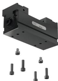
Per rendere possibile il fissaggio da sotto la versione di base dispone di 2 x  $\varnothing 8^{H7}$  fori di precisione e di 4 fori filettati M8 per il posizionamento.
