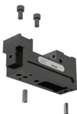
Nella versione base il posizionamento viene effettuato con 2 fori  $\text{Ø}8^{\text{H7}}$  con i quali l'ESG mini 40 mm può essere allineato su piastre a reticolo (codice 80 897 944 e 80 897 946) e una piastra con scanalature a T. Il dispositivo di bloccaggio ESG mini 40 può essere fissato attraverso due viti M8 da sopra. **In alternativa** il fissaggio avviene con 4 viti M6 da sotto.
