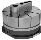
MNG'ye monteli Alüminyum pens vasıtasıyla bağlanmış iş parçası
