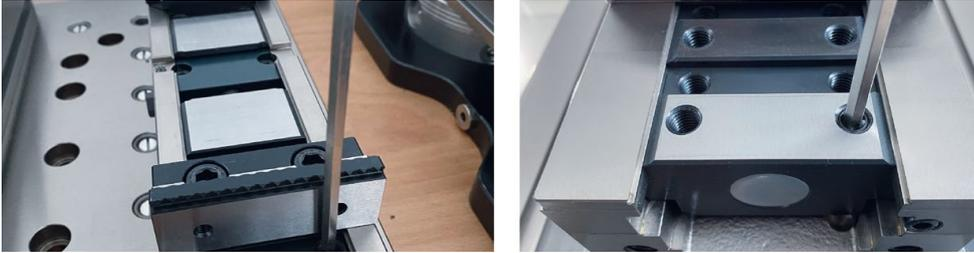
O pino roscado com encaixe hexagonal bloqueia a guia deslizante traseira e o DSG 4 também pode ser usado como uma morsa de fixação simples **Aviso importante:** Não adequado o uso de várias morsas como morsas simples lado a lado. Recomendamos a modificação com um canal transversal adicional no corpo-base e mordente fixo correspondente.
