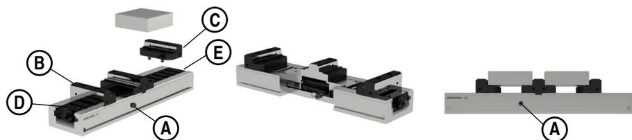
Se o parafuso lateral A estiver apertado, afrouxe-o girando-o cerca de 1/2 volta. Com a morsa totalmente aberta, posicione as mordentes de fixação B e C nos canais das guias deslizantes D e E mais adequadas dependendo do tamanho da peça. Duas peças de tamanhos diferentes também podem ser fixadas.
