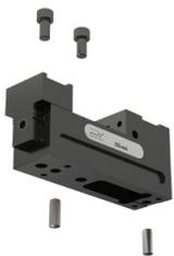
Dans la version de base, le positionnement s'effectue à l'aide de 2 trous Ø8<sup>H7</sup>, avec lesquels l'étau ESG mini 40 mm peut être aligné sur des tables de machines avec rainures en T ou sur les plaques de fixation figurant à la page 58. **Référence 80 897 944 et 80 897 946** L'étau ESG mini 40 mm peut être également fixé par le dessus avec 2 vis M8.
