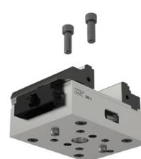
Toutes les variantes disposent d'alésages de précision  $\text{Ø}12^{\text{H7}}$  avec lesquels le ZSG 4 peut être positionné de façon précise. Toutes les variantes peuvent être fixées par le dessus à l'aide de vis passant au travers du corps de base.
