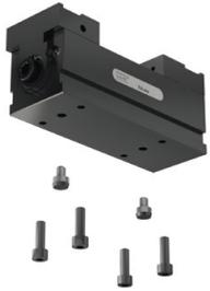
Pour une fixation par le dessous, la version de base comporte 2 trous de précision  $\text{Ø}8^{\text{H7}}$  pour le positionnement et 4 trous taraudés M8.
