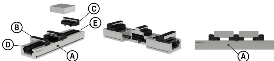
La vis latérale (A) n'est pas serrée et doit être libérée d'un 1/2 tour supplémentaire. Avec l'étau ouvert au maximum, placez respectivement les mors (B) et (C) dans les rainures (D) et (E) disponibles et correspondant à la taille de la pièce à serrer. Nota : Les pièces à serrer peuvent être de dimensions différentes
