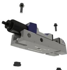
Alineación mediante ranuras longitudinales y transversales 20<sup>H7</sup> en el cuerpo base y tuercas en T de precisión a la mesa
