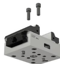
En todas las versiones hay agujeros de precisión de  $\varnothing 12^{H7}$ , con los que se puede alinear la ESG 5 de forma exacta. Todas las versiones pueden fijarse con tornillos desde arriba a través del cuerpo base.
