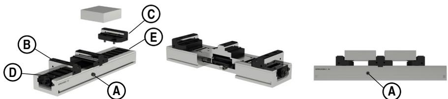
Si el tornillo lateral A está apretado, aflójelo girándolo aproximadamente 1/2 vuelta. Con la mordaza abierta al máximo, coloque las bocas base B y C en las ranuras de las guías D y E, más apropiadas dependiendo del tamaño de la pieza a amarrar. Se pueden amarrar 2 piezas de diferentes tamaños.
