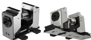
Justering via præcisions T-not mætrikker 20 H7 i basisenheden (H5G) og justeringssæt 14/16/18 i maskinbordets T-not. Opspænding med spændejern.
