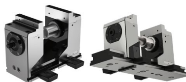
Ausrichtung durch Präzisions-Nutensteine 20 H7 im Grundkörper (H5G) und Ausrichtsätze 14 / 16 / 18 in der T-Nut des Maschinentisches. Aufspannung mit Spannpratzen.
