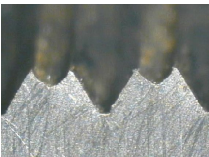
Conformado demasiado débil – agujero previo demasiado grande
