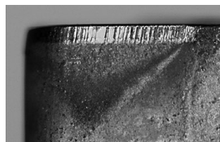
Usure en dépouille
