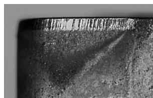
Износ по задней поверхности: нормальный износ по истечении определенного времени обработки.
