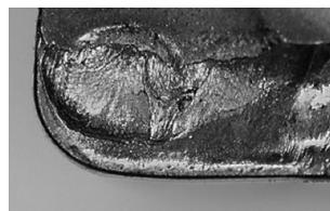
Сход нагретой стружки приводит к лункообразованию на передней поверхности пластины.
