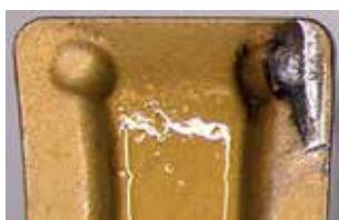
Odtekajoči vroči odrezki povzročajo erozijo rezalne ploščice na cepilni ploskvi.
