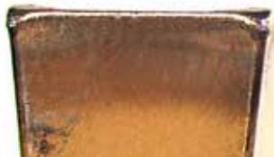
Visoka mehanska obremenitev povzroča visoke temperature strojne obdelave, kar lahko vodi do oblikovne deformacije.
