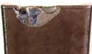
Visoke mehanske obremenitve rezilnega roba lahko vodijo do odloma HM-delcev.
