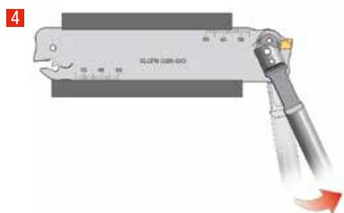
Montažni ključ obrnite naprej. Ležišče ploščice se ponovno zapre, zarezovalna ploščica pa se vpne.
