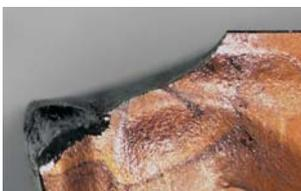
Une surcharge sur la plaquette peut entraîner sa rupture.
