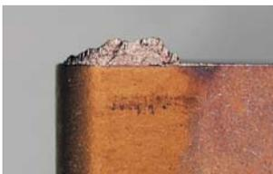
Des particules de matière se collent sur l'arête lorsque le copeau n'est pas évacué normalement en raison d'une température de coupe trop basse.
