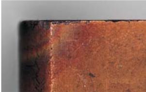
Dû à la surcharge mécanique de l'arête de coupe, des particules de carbure peuvent se détacher.
