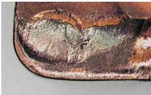
Le flux de copeaux chauds provoque une cratérisation de la plaquette sur la face de coupe.
