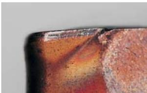
La combinaison d'une température d'usinage élevée et d'une charge mécanique peut provoquer une déformation plastique.
