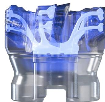
*Porte-outil réalisé en impression en 3D avec des canaux de lubrification idéalement positionnés*
