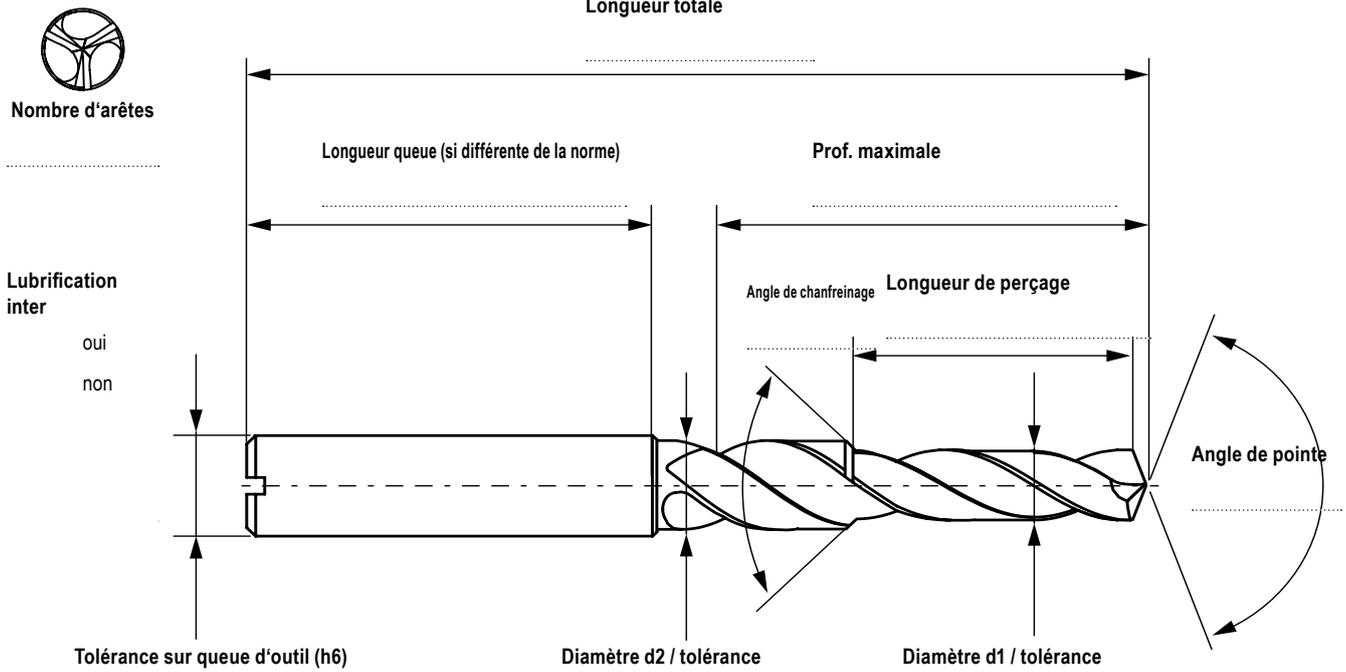
**i** En raison des exigences de performance, l'angle de pointe des outils de perçage n'est pas constant et est plus important à proximité de l'axe. Si un angle de pointe constant est requis, veuillez le préciser.
