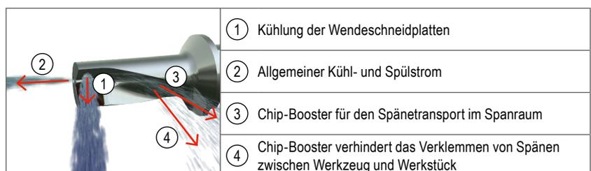
**1** Um einen effizienten Spänetransport aus einer Bohrung zu gewährleisten, muss der Kühlmitteldruck mindestens 3–6 bar (optimal 7–10 bar) betragen.
